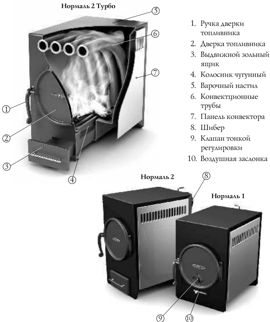
Рисунок 2. Расположение основных элементов печи «Нормаль».
